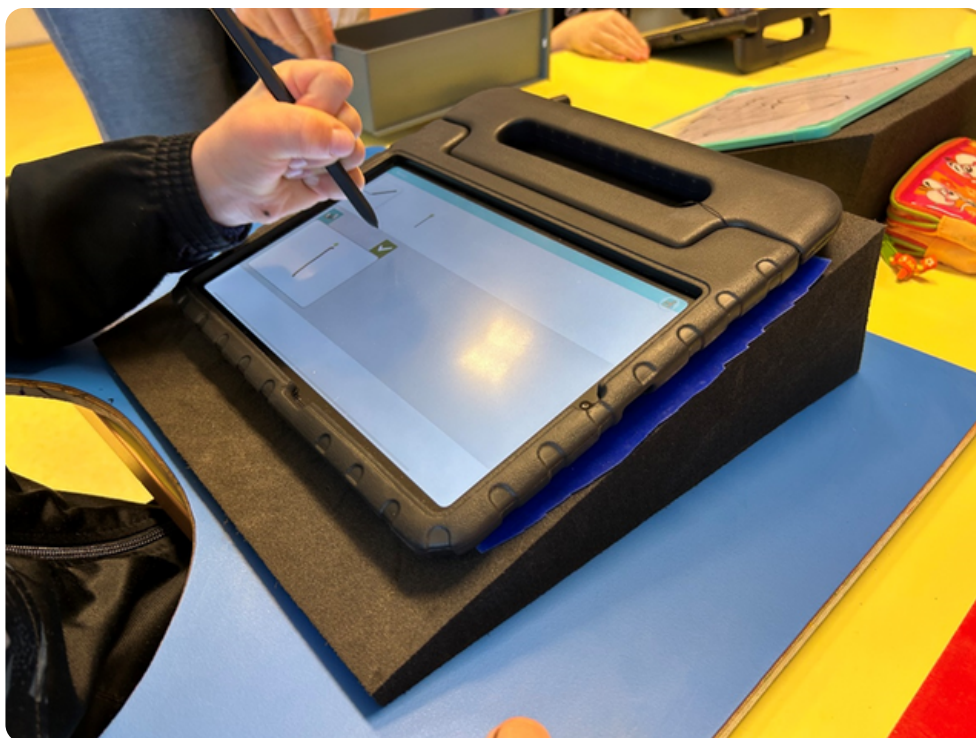
Figure 14 : Plan incliné - Le changement d'angle se fait avec différents types de mousse
